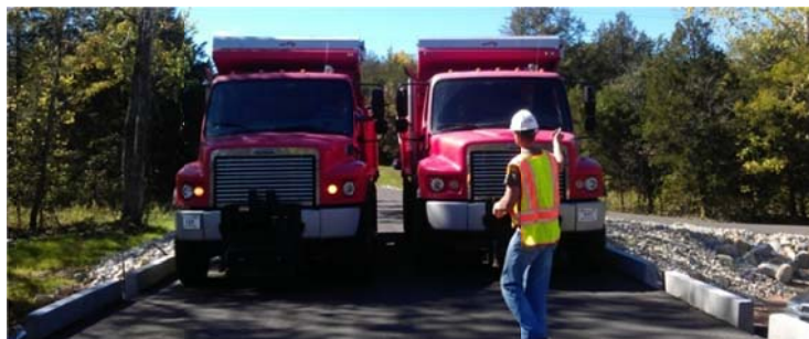
(d) Load cases with two trucks
